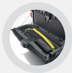
Einsatz für Ladekabel anstelle Dachholme in Heckklappenablage (Cabrio) (I20)
